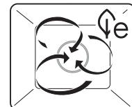
Данная программа особенно энергосберегающая. Воздух в камере прогревается нагревательным элементом, расположенным за задней стенкой камеры, и равномерно циркулирует. Влага, выделяемая продуктом, остается в камере. Приготвляемое блюдо не пересыхает.
